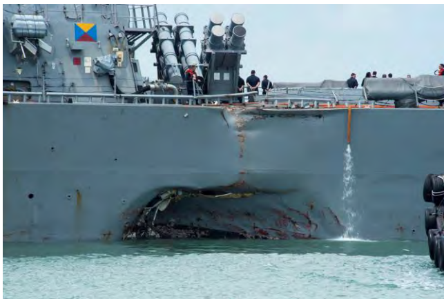
Fig 1 - Damage to USS John S. McCain (DDG 56)
