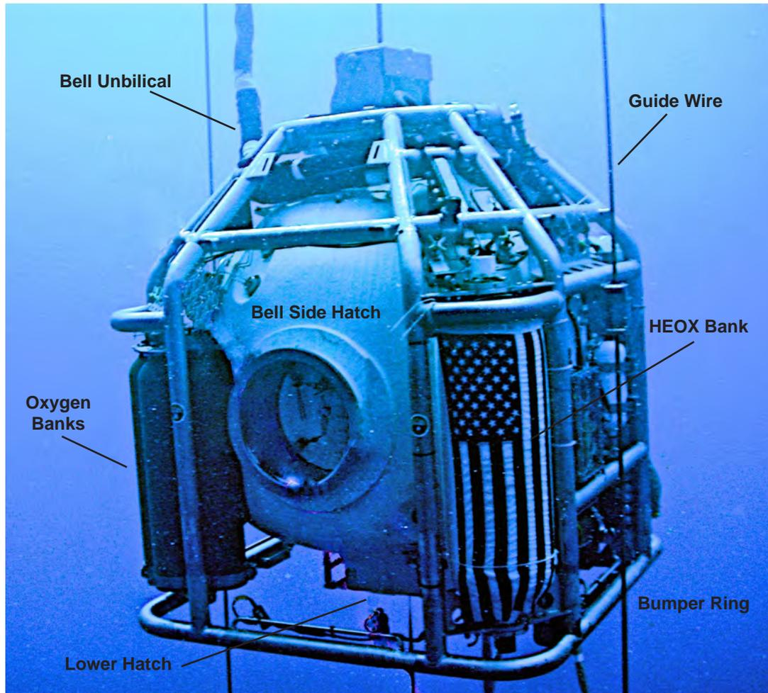
Figure 13-2. SAT FADS Dive Bell Exterior.
